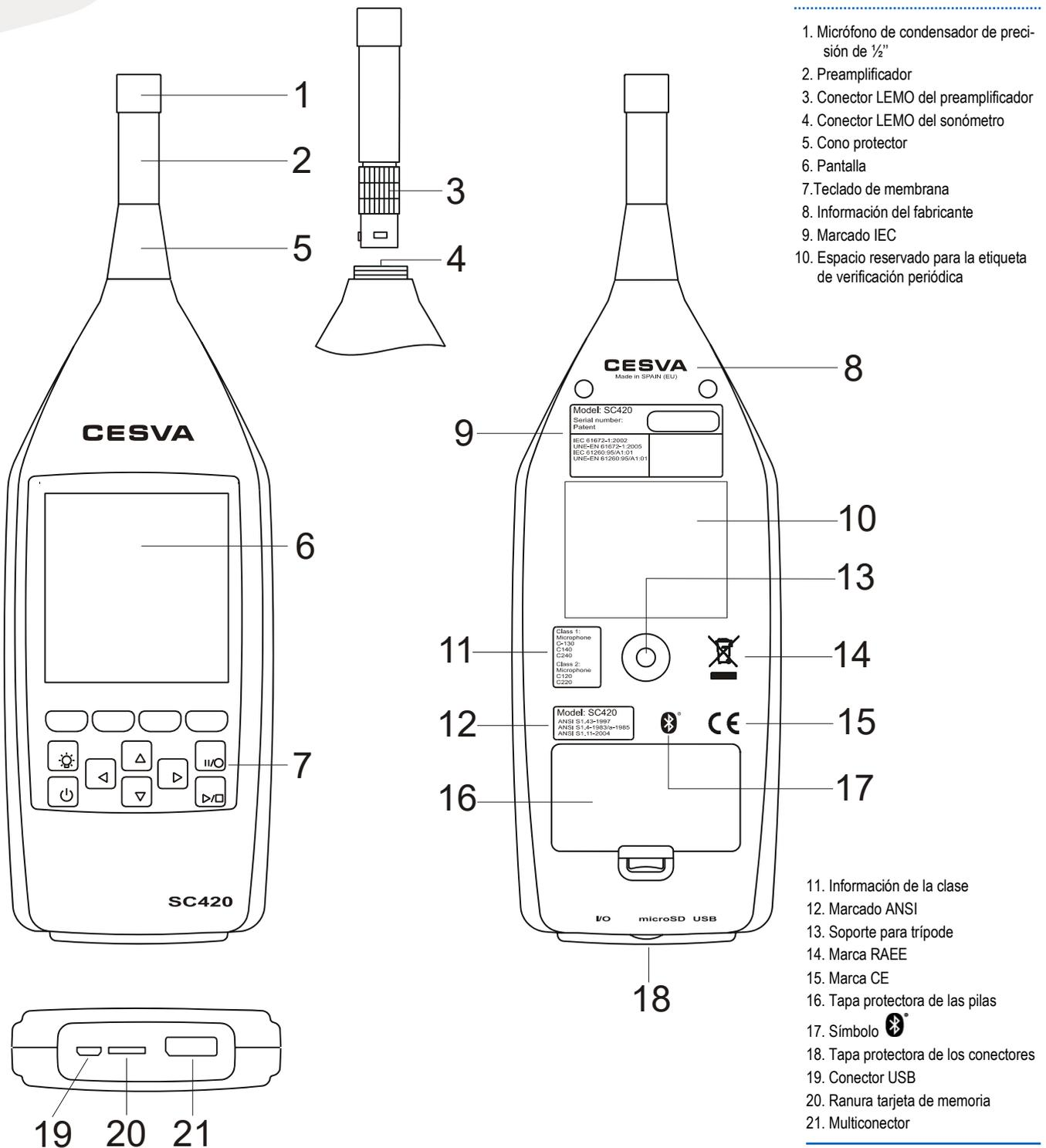
1. Micrófono de condensador de precisión de 1/2"
