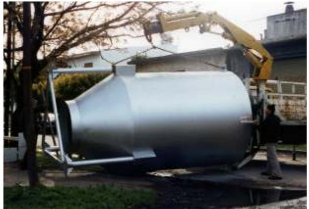
aislantes al espectro de ruido a atenuar y el largo para lograr la eficiencia necesaria. Se diseñan con sección rectangular, con canales paralelos y de sección rectangular, con canales paralelos y de sección circular con canales anulares concentricos adaptando sus dimensiones a las de las aberturas donde se deban instalar.
