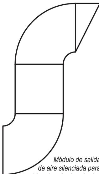
Módulo de salida de aire silenciada para cabina de máquina térmica
